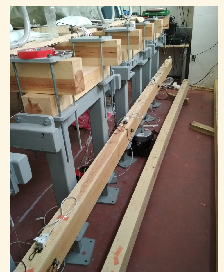
Fig. 4 Set-up vigas libres.
